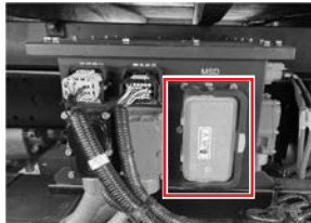
150kWh 배터리 PRA 장착 MSD : 1개
